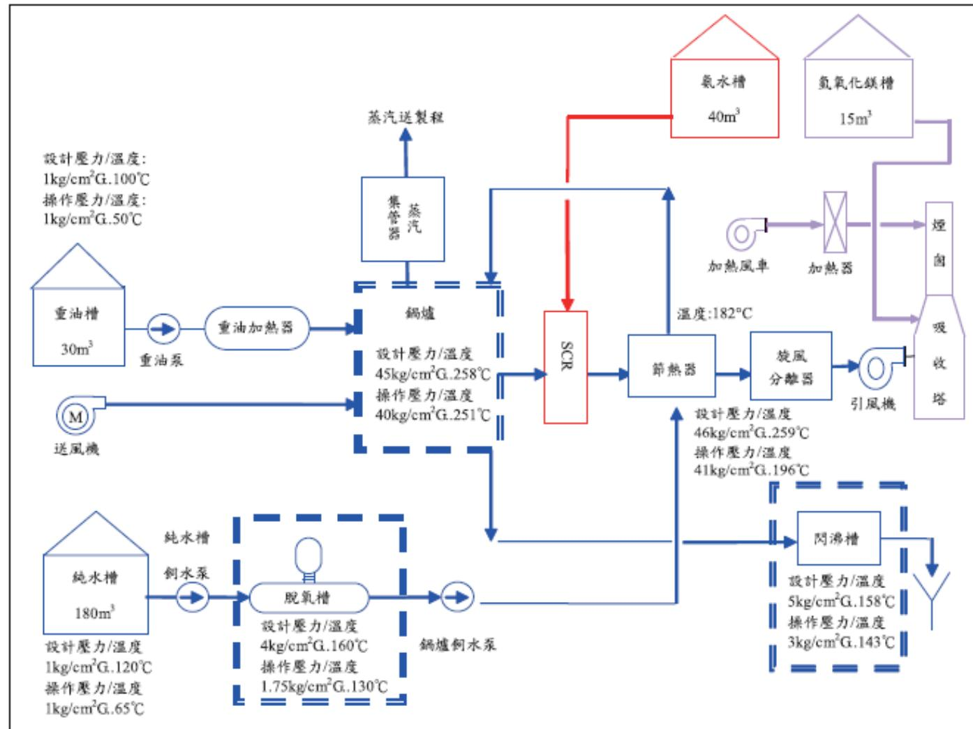
蒸汽鍋爐方塊流程圖
